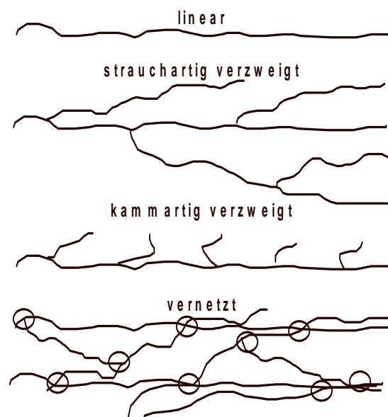
Abbildung 1: Kettenstruktur von Makromolekülen
