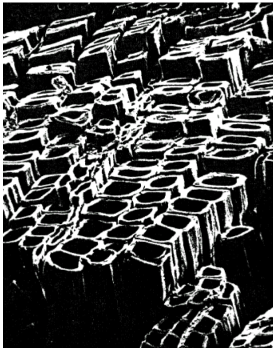
Abbildung 4: Geschnittene Fasern im Hackschnitzel nach vollständiger Delignifizierung
