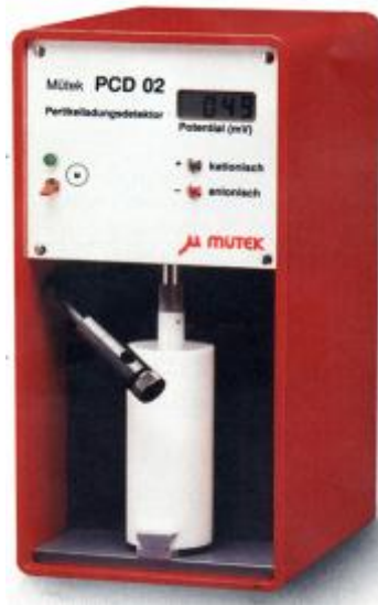
Abbildung 13: Kommerzielles Gerät zur Polyelektrolyt-Titration
